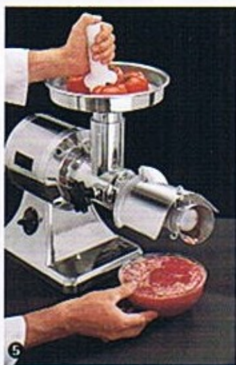
4-Passapomodoro per TC/TCG 22E Tomato sauce making for TC/TCG 22E Anbringung Tomatenbreiteil für TC/TCG 22E Application passe-tomate pour TC/TCG 22E
